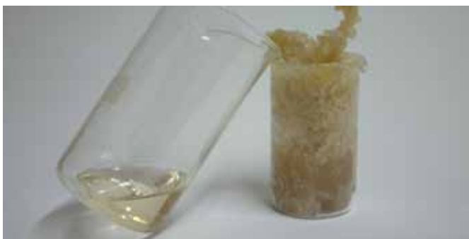
dcha: una resina con un micro-relleno del 38% da una masa resquebrajada izqda: la misma resina con un nano-relleno del 40% queda líquida.
