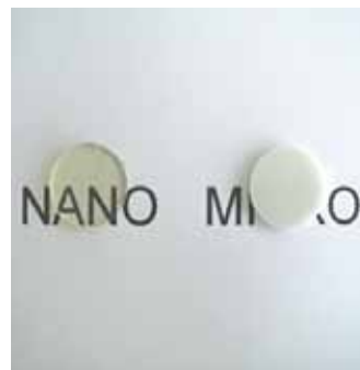
Un polímero relleno con nano-partículas es claro y translúcido, el polímero micro-relleno, sin embargo, es opaco
