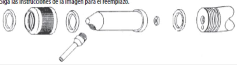
El diagrama muestra un MicroEtcher desmontado para el reemplazo del anillo circular. Se ven: un anillo circular separado, el cuerpo principal con el anillo circular instalado, un eje de recolección con la cámara de abrasivo, y el MicroEtcher ensamblado con el nuevo anillo circular. |
