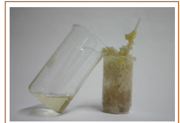
Dcha: una resina con un micro-relleno del 38% da una masa resquebrajada. Izqda: la misma resina con un nano-relleno del 40% queda líquida.
