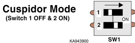
Figure 5-7. SW1 Switch (Cuspidor)
